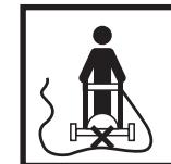
Избегайте попадания шнура питания под нож газонокосилки
