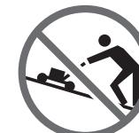
Не эксплуатируйте устройство на склонах с уклоном более 20°. Подстригайте траву в первичном направлении к спуску склона, а не в направлении подъема и спуска.
